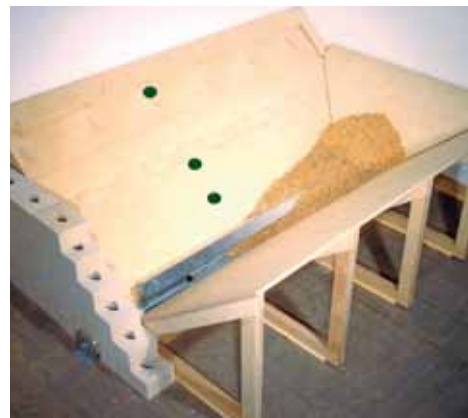
Abb. 25 Drucksensoren zur Füllstandsmessung im Schrägbodenlager
